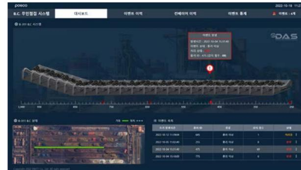
**POSCO Belt Conveyor Idler Roller 무인점검 시스템**
